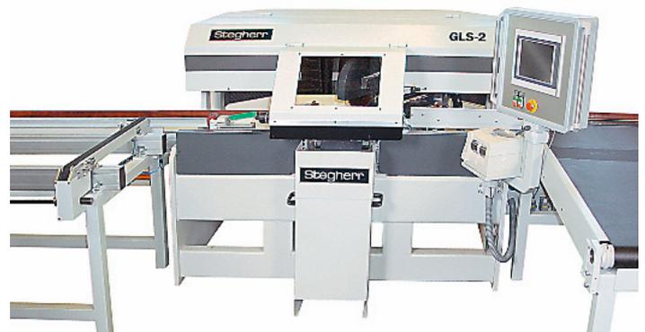
Achsen gesteuerte Sägewinklereinstellung in zwei Ebenen bietet die Stegherr Glasleistensäge GLS-2 von Stegherr
