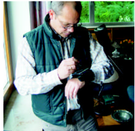
Ein Taschencomputer am Handgelenk dient als Aufmaßformular
