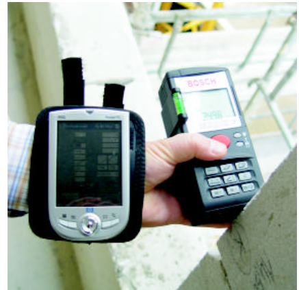
Das Längenmessgerät überträgt die Abmessungen der Laibung per Funk an einen PDA
