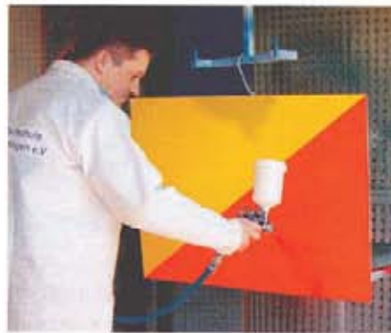
Das Lackspritzen ist im Tischler- und Schreinerhandwerk nach wie vor Stand der Technik zum Erzielen hochwertiger Oberflächen. Jeder Betrieb sollte sich jedoch kundig machen, welche Spritztechnologie für ihn die richtige ist
