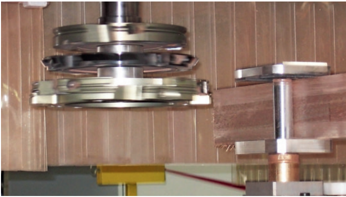
/ Möglich, aber z. B. im Hinblick auf hohe Systemvielfalt eingeschränkt: Schlitz- und Zapfenfertigung auf dem CNC-Bearbeitungszentrum (Foto: Homag)
