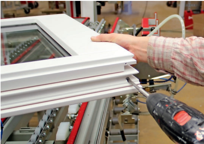
/ Auf einem speziellen Montagetisch werden die Einzelteile des Flügels mit angefräster Glasleiste um die Scheibe herum zusammengesteckt und verschraubt.
