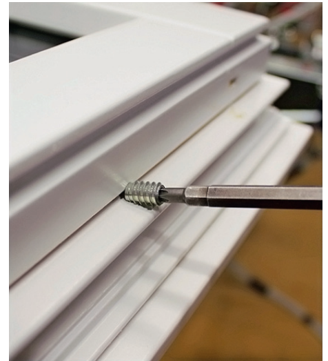
/ Funktionsprinzip der von außen verstellbaren Verklötzung: Mittels einer Stellschraube von außen kann man die Klötze verstellen und somit bei montierten Rahmen die statische Funktion der Verklötzung herstellen. Nachträgliches Verstellen ist jederzeit möglich.
