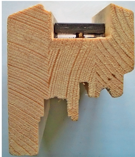
/ Funktionsprinzip der von außen verstellbaren Verklötzung: Mittels einer Stellschraube von außen kann man die Klötze verstellen und somit bei montierten Rahmen die statische Funktion der Verklötzung herstellen. Nachträgliches Verstellen ist jederzeit möglich.
