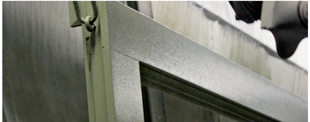
/ Präzise Robotertechnologie: Exakt abgestimmte Spritzvorgänge verringern den Overspray spürbar.
