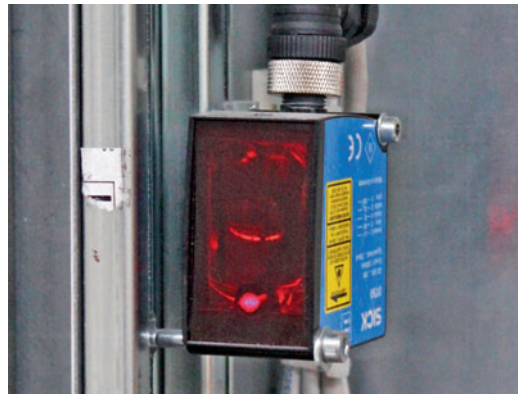
/ Mittels Lasermessung werden die Werkstückdicke und -neigung im hängenden Zustand sehr genau ermittelt.
