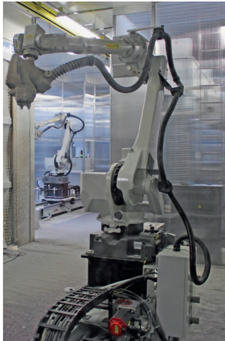
/ Die Spritzlackierung erfolgt effektiv mittels zweier versetzt arbeitender Roboter aus dem Hause Fanuc.
