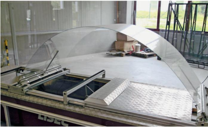
/ Sehr bruchstabil: 2 mm teilvorgespanntes Glas (TVG) im Biegebruchtest
