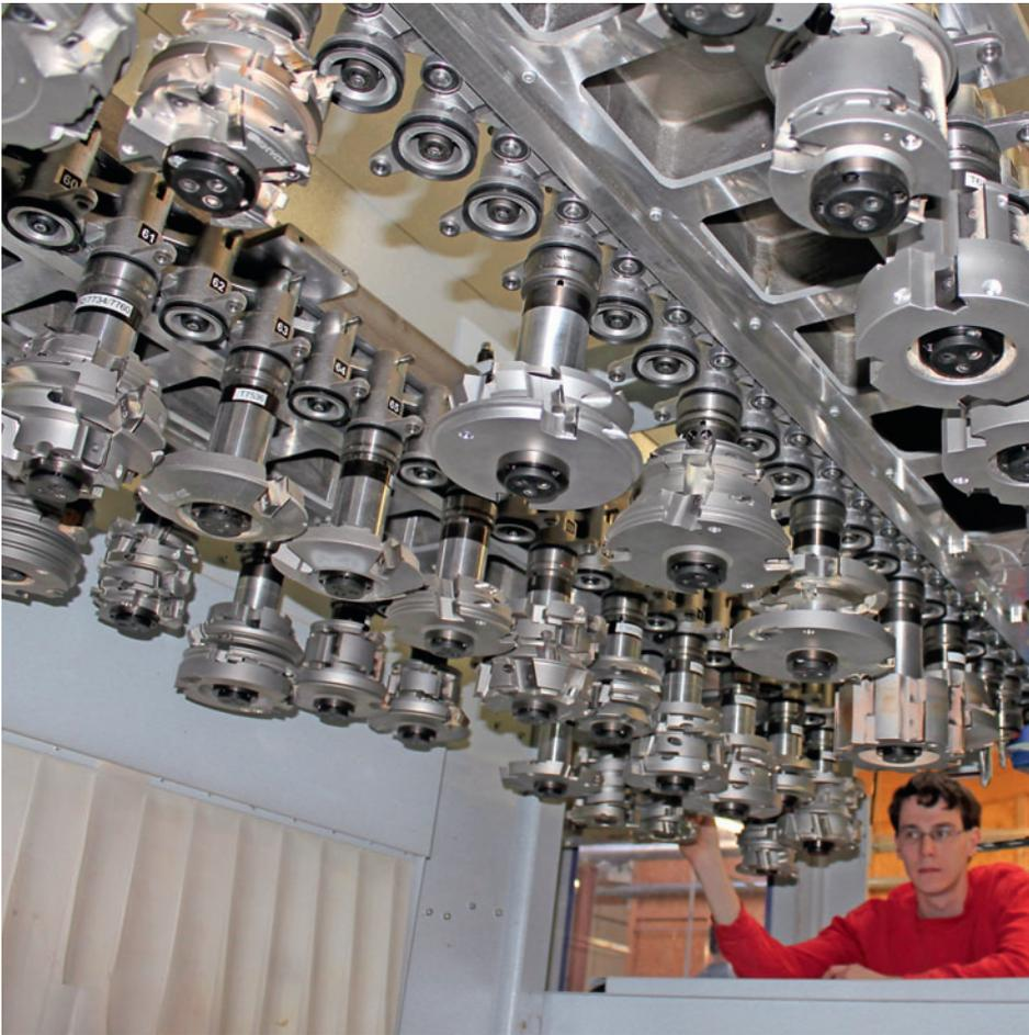
/ Der Werkzeugwechsler des Powerprofilers ist mit mehr als 100 Werkzeugen für IV80 und IV90 bestückt.
