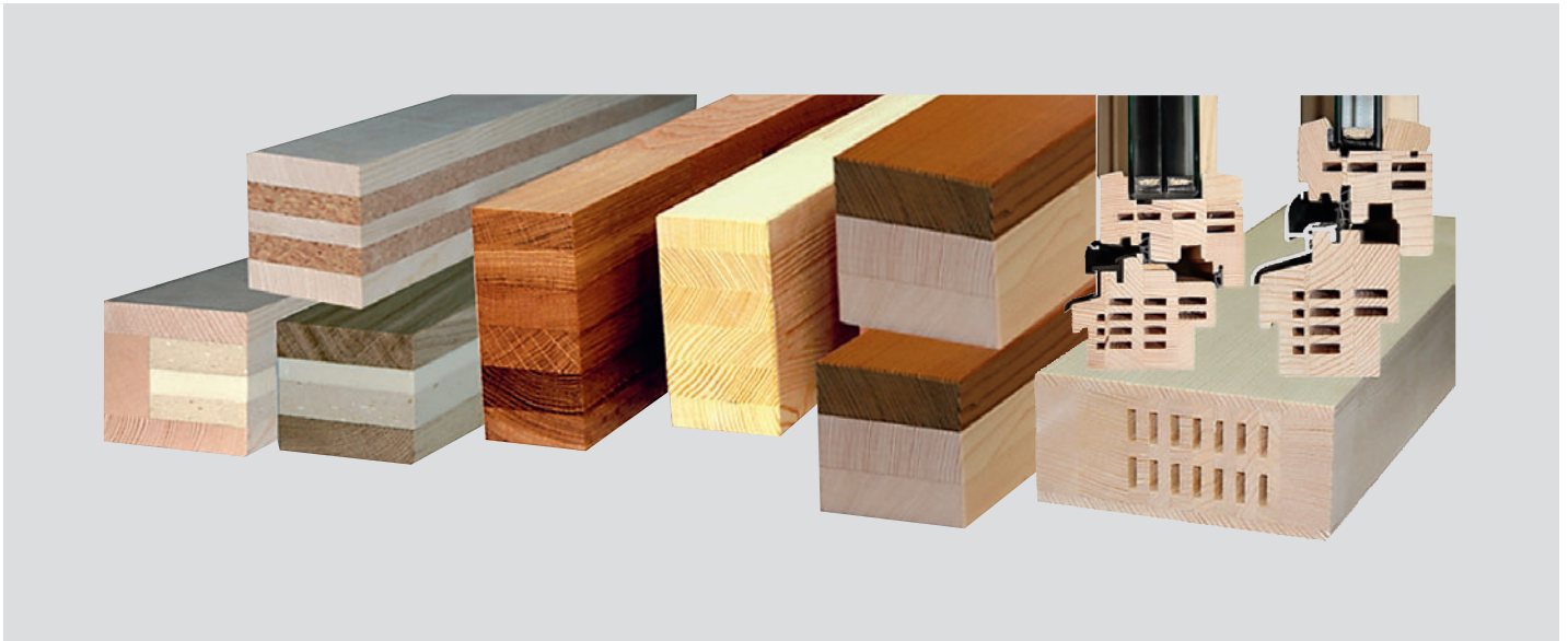
/ Die Vielfalt steigt mit den Anforderungen: Links drei Spezialkanteln mit Wärmedämmschicht, anschließend zwei Wintergartenkanteln sowie Kanteln mit Decklage aus Thermoholz und rechts hochwärmedämmende Spezialkanteln mit Hohlräumen.
