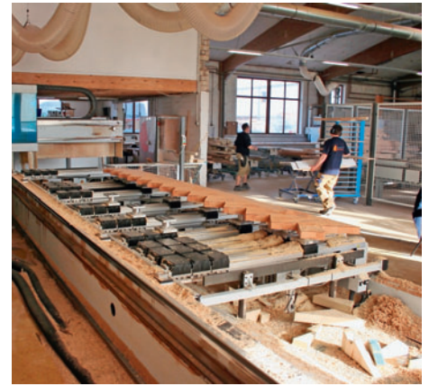
/ Homag BOF 322 für Teile bis 6 m Länge
