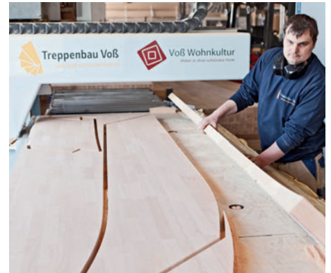
/ Materialoptimierung ist Trumpf: Die BOF 211 wird zum Treppennesting eingesetzt.
