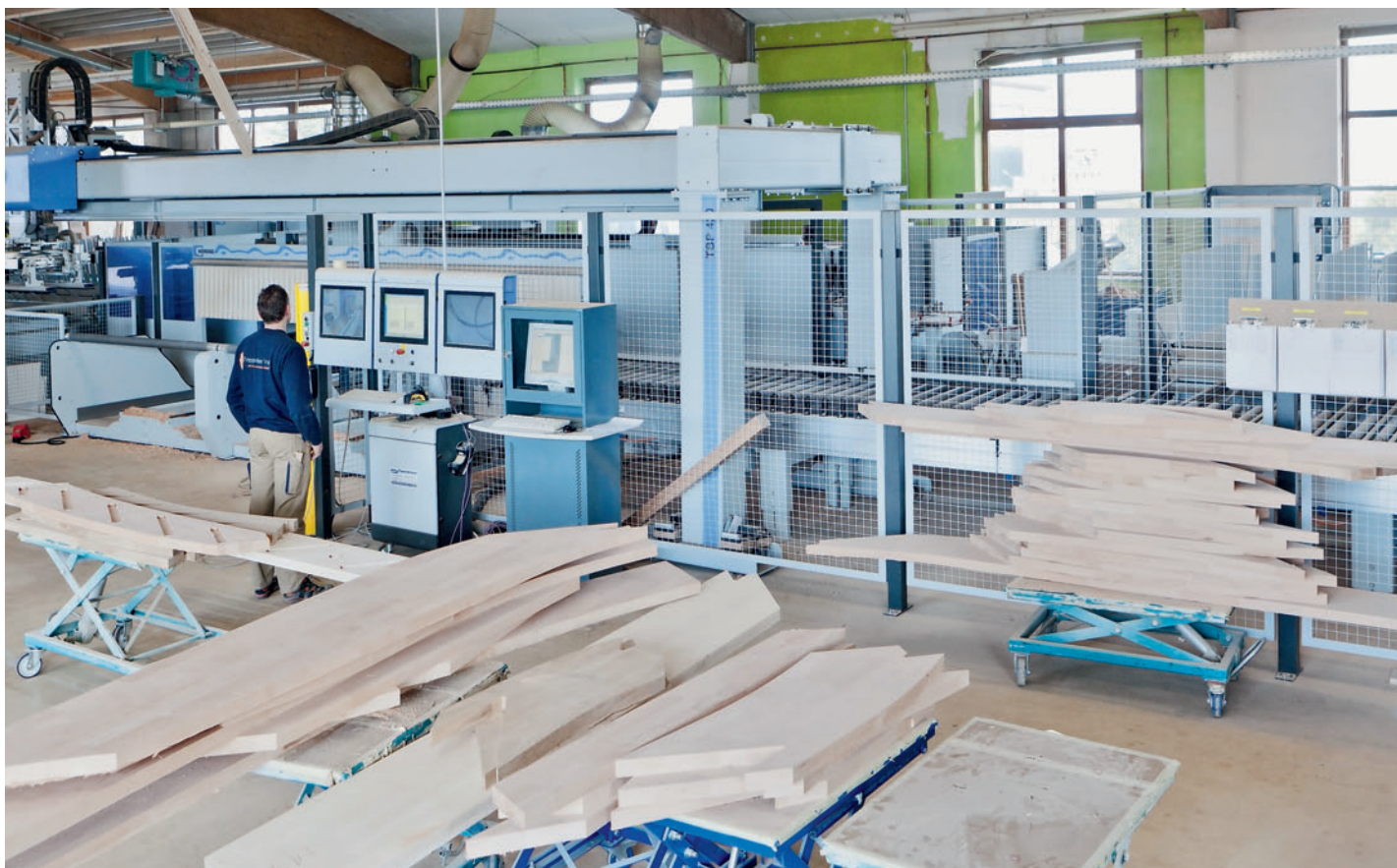
Herzstück der Fertigung bei Voß ist das Homag BAZ 722 in Verbindung mit der automatischen Beschickung von Bargstedt. Die Ansteuerung erfolgt durch die Treppenbaust software New Dimension BarCode aus dem Hause Compass Software.
