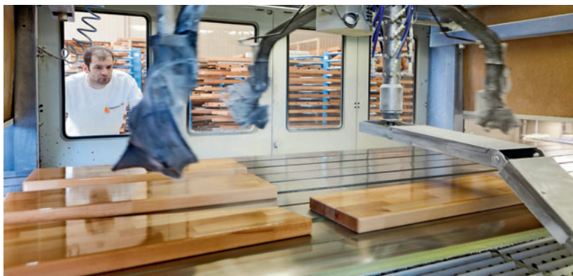
/ Auf der automatischen Spritzanlage von Catin Air sorgen oszillierende Spritzdüsen für eine hochwertige Oberflächenbeschichtung der Treppenteile.
