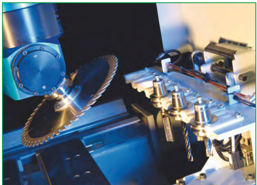
Bild 123/4: In eine 4-Achsmaschine einwechselbares 5-Achsaggregat
