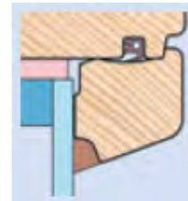
Bild 43.) Glasleiste überfälzt mit Glasleistendichtung
