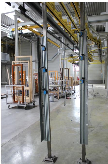
Bei zweidimensionalen Scan-Systemen werden die zu spritzenden Teile durch eine Lichtleiste erfasst. Quelle: Wertbau
